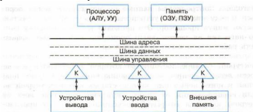
Рис. 2.7. Функциональная схема компьютера (К — контроллер)
